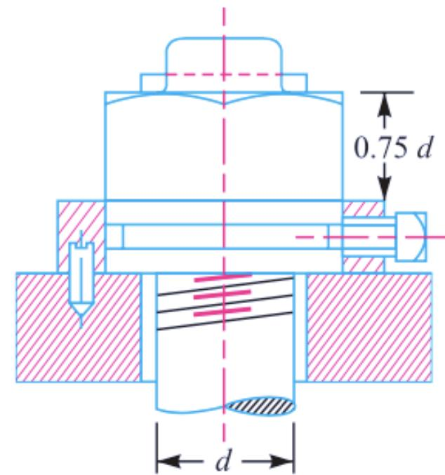
Fig. 11.18. Penn, ring or grooved nut.
