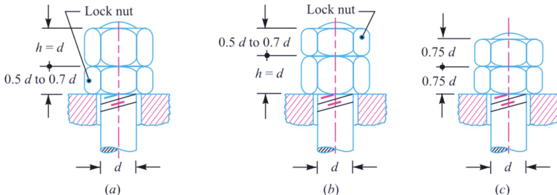
Fig. 11.15. Jam nut or lock nut.
